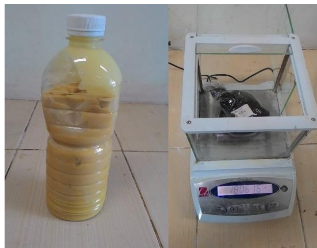
Gambar 3. Zat padat hasil pirolisis limbah plastik HDPE (a) Sejenis nafta dan (b) Karbon aktif
