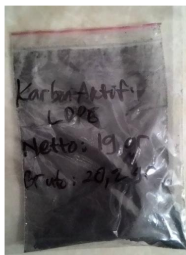
Gambar 7. Karbon aktif hasil pirolisis limbah plastik LDPE
