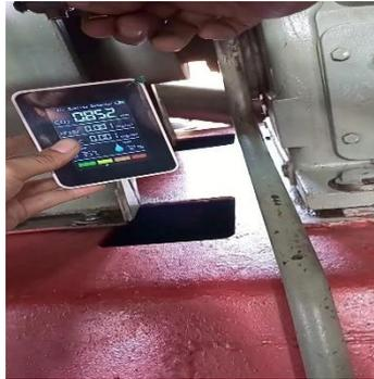
**Gambar 7.** Pengujian Kualitas Udara pada Kompresor
