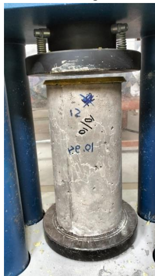
Gambar 3. Pengujian Kuat Tekan Benda Uji Silinder Umur 28 Hari
