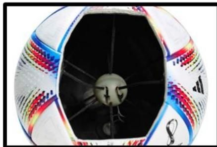
Gambar 7. Sensor dalam bola jarak menengah
