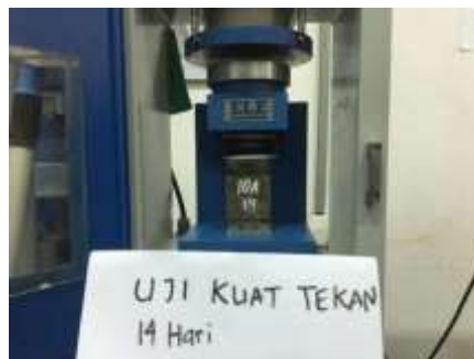
Gambar 8 Pengujian Kuat Tekan Benda Uji Mortar Geopolimer
