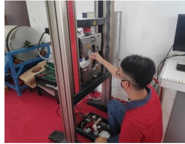
Gambar 4 Pengujian Spesimen Uji tarik
