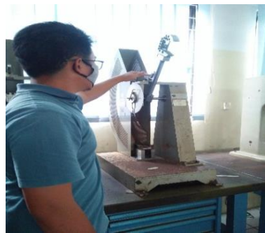
Gambar 5 Pengujian Spesimen Uji Impact
