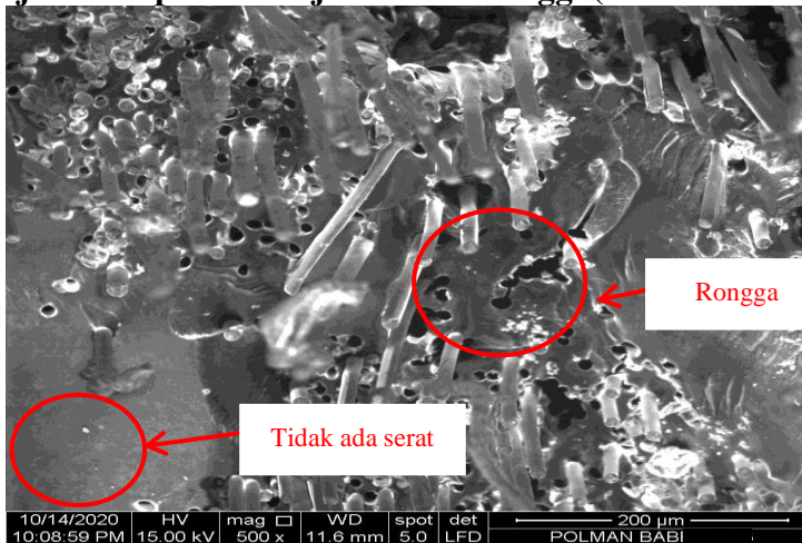
Gambar 18 Hasil Uji SEM Spesimen Uji Impak Terendah (Perbesaran 500 kali)
