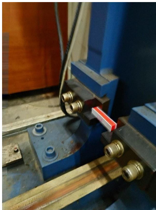
Gambar 15 Spesimen Ditempatkan Pada Alat Uji
