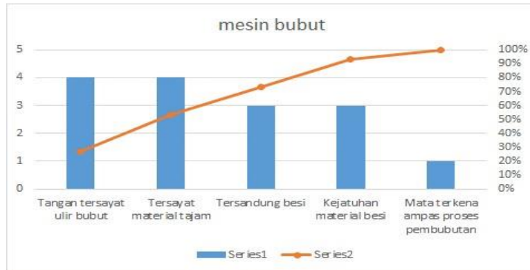
Gambar 6 Kecelakaan Kerja pada Mesin Bubut Tahun 2019
