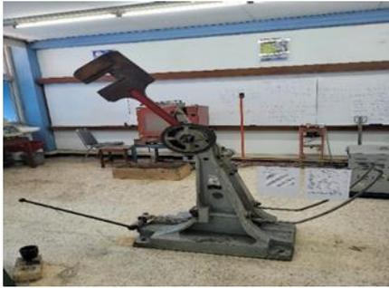
Gambar 3 Alat Uji Impak Charpy
