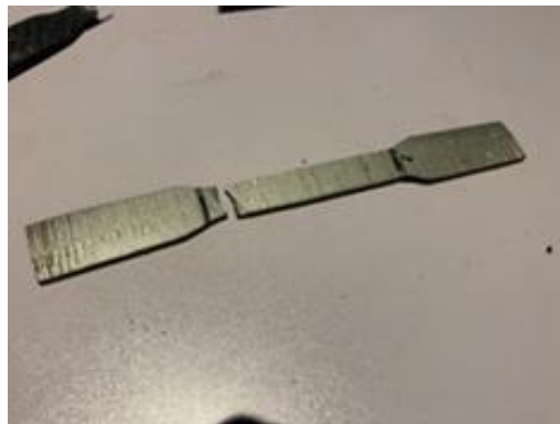
Gambar 3 Hasil Pengujian Tarik Komposit Bodykit
