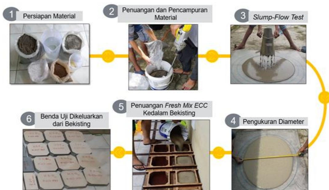
Gambar 3. Proses pembuatan benda uji
