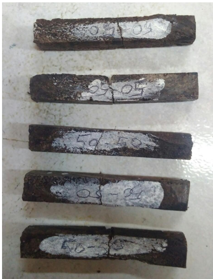
Gambar 2. Gambar bentuk patahan hasil uji impact
